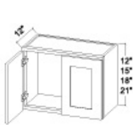
W1812 W2412/W2415/W2418/W2421 W2712/W2715/W2718/W2721 W3012/W3015/W3018/W3021 W3312/W3315/W3318/W3321 W3612/W3615/W3618/W3621 W3918
